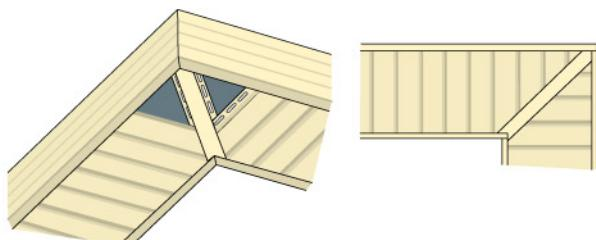
Соффит устанавливается между молдингом и J-фаской. Технология монтажа соффита очень проста: отрезается панель нужного размера за вычетом зазора на установку. Один конец заводится в молдинг, другой в J-фаску. Следующий соффит монтируется таким же образом и защелкивается в замок первого, и так далее.
