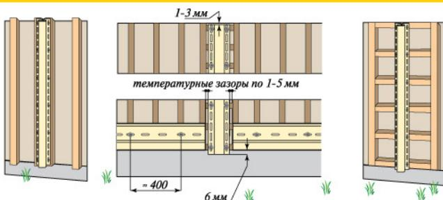
H-профиль устанавливается по технологии внешнего и внутреннего угла. Для его монтажа нужно обязательно подготовить места крепления.
