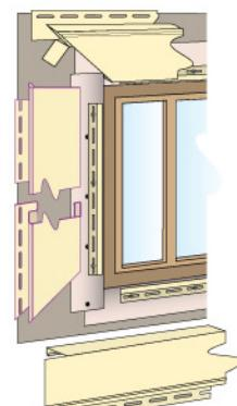
Наличник 89 мм Дёке. Перед установкой наличника по всему периметру окна устанавливаются отрезки стартового профиля. Готовляем наличники на оконный проем, длина всех элементов должна быть равной, соответственно, длине и высоте проема плюс две высоты используемых наличников. У верхнего наличника в J-составляющей с обеих сторон делаются надрезы длиной 20 мм, и эти «язычки» отгибаются вниз, по ним вода с верхнего наличника будет отводиться в боковые.
