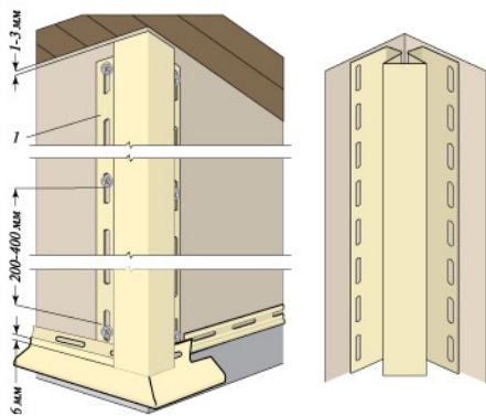
Внешние и внутренние углы устанавливаются на стыках стен так, чтобы их верхняя часть была на 1-3 мм ниже карниза или сoffита, а нижняя часть на 4-6 мм ниже стартового профиля.
