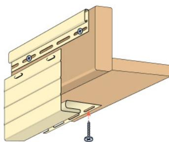
Горизонтальные J-фаски устанавливают по правилам крепления горизонтальных элементов, наклонные J-фаски крепят по правилам установки вертикальных элементов. К верхней кромке ветровой доски крепится финишный профиль. Фаска защелкивается в финишную планку на «зажцы». При необходимости удлинить J-фаску элементы закрепляются внахлест на величину 25 мм.
