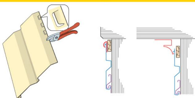
Финишный профиль и молдинг устанавливают на стене непосредственно под карнизом крыши или сoffитом.
